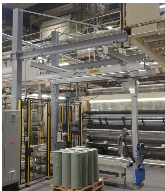
Skensystem med dubbeltravers placerade i stora överstagade stålgalgar.
