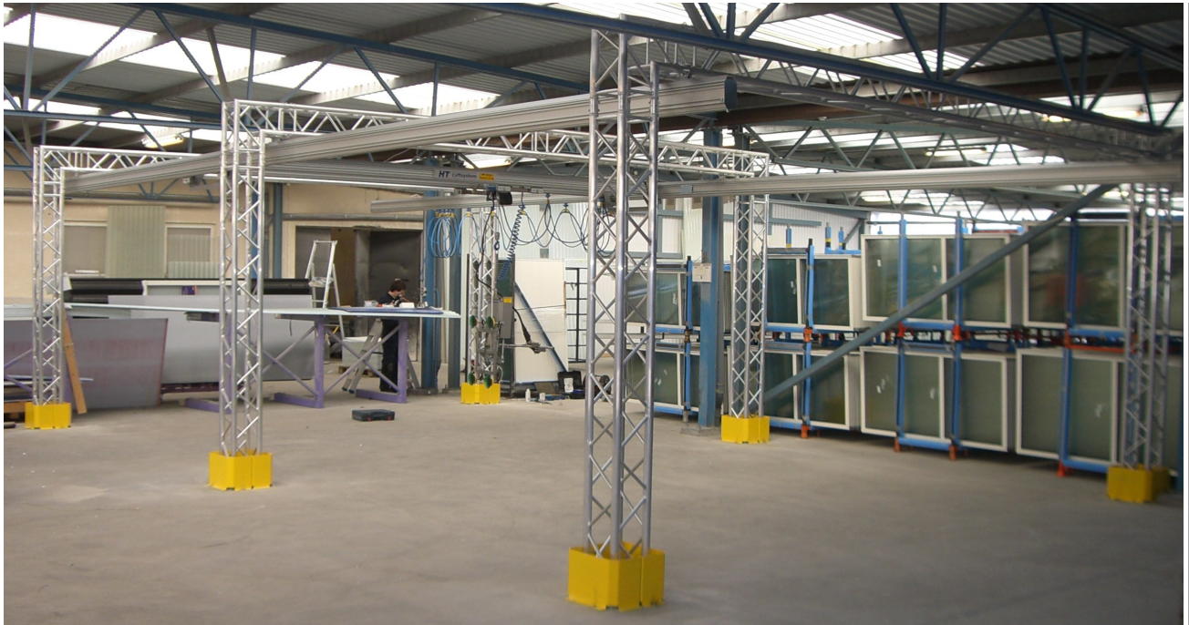
Skensystem med enkeltravers placerat i 3st. Trossbågar.
