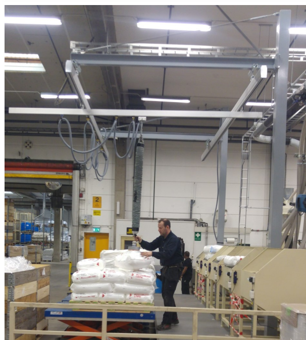
Skensystem med enkeltravers, placerade i stora överstagade stålgalgar.
