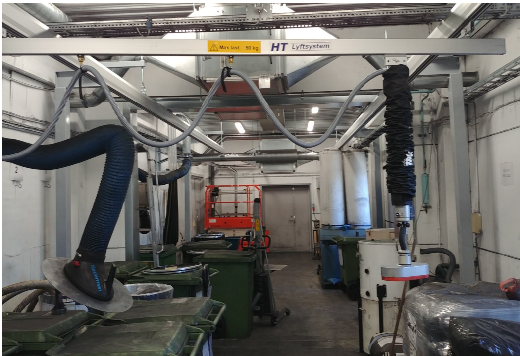
Skensystem med en enkeltravers och en vakuumslanglyft placerat i ståljalgar.
