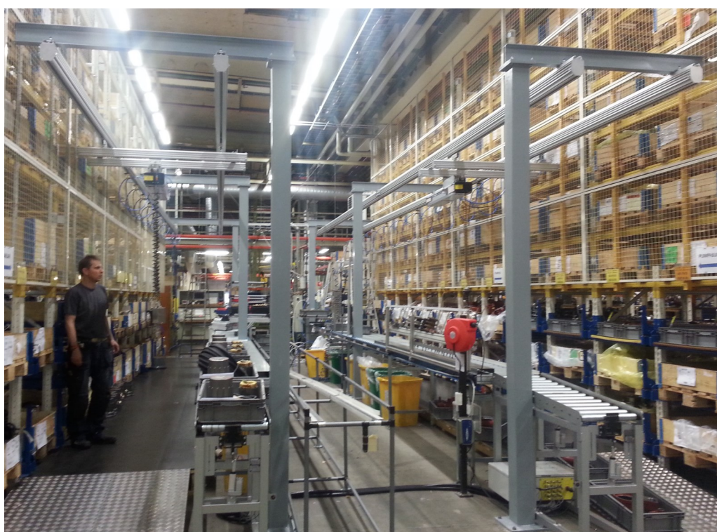
2st långa skensystem med små dubbeltraverser placerade i många ståljalgar.
