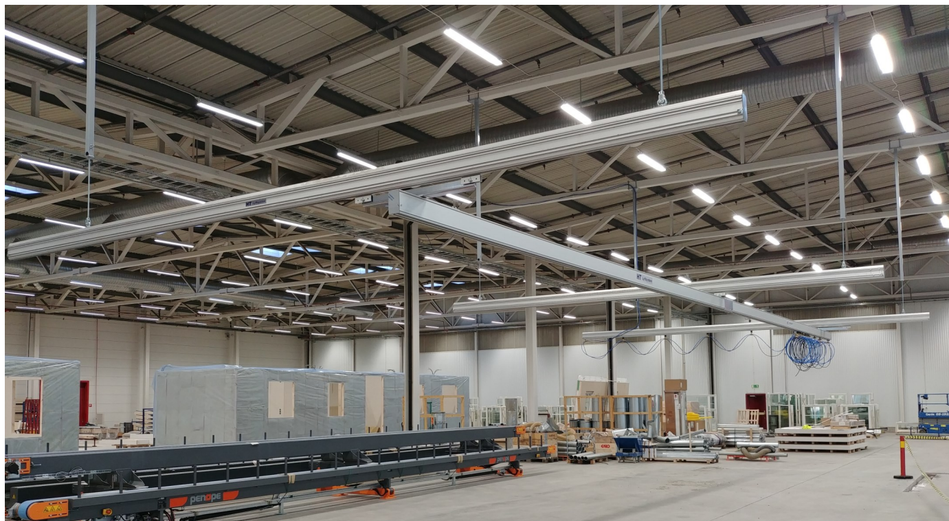
Skensystem med 3st banbalkar och en lång traversbalk samt långa pendlar från takbalkarna.
