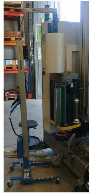
Mekanisk rullexpander p4 anpassad lyftbom
