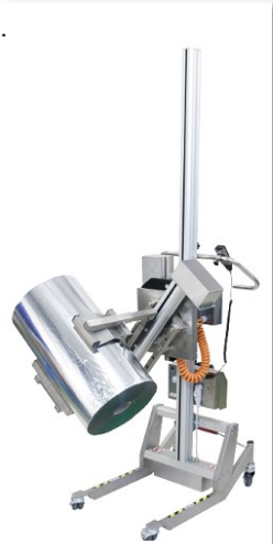
Lyftvagn med elektrisk kläm och vrid
